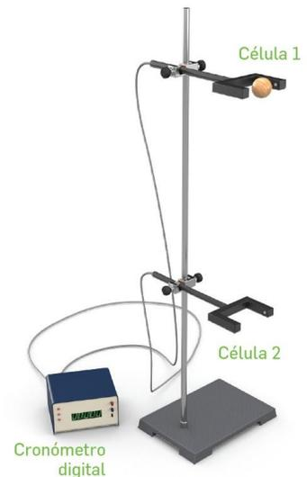
Figura 1 - Montagem para determinar a aceleração média no movimento de queda de uma esfera.
