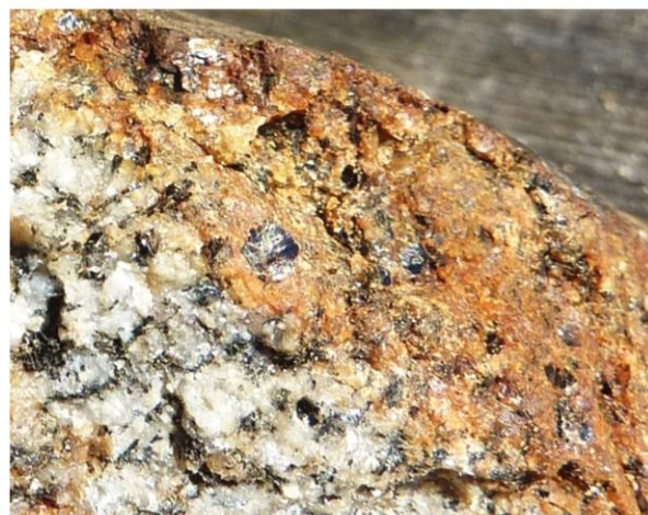
Figura 5 – Nesta amostra de granito, alguns minerais ferromagnesianos - a biotite e a anfíbola - foram alterados por oxidação, originando limonite (zona amarelo-alaranjada), que é uma mistura de óxidos e hidróxidos de ferro (Steven Earle / https://environmental-geology-dev.pressbooks.tru.ca ).
