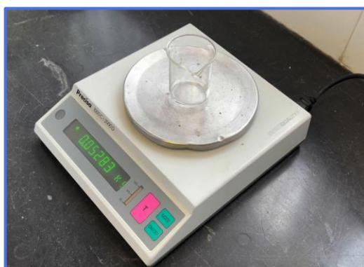
Figura 5 – Imagem retirada da videoaula [Medição de massas e volumes](#). (Massa do copo com 100 gotas de água)
